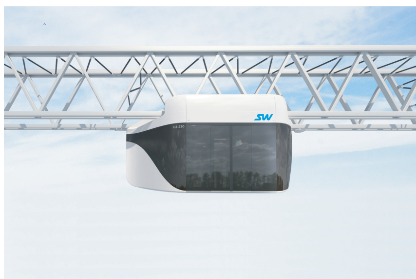
Рис. 4. Общий вид 14-ти местного подвесного бирельсового юнибуса
