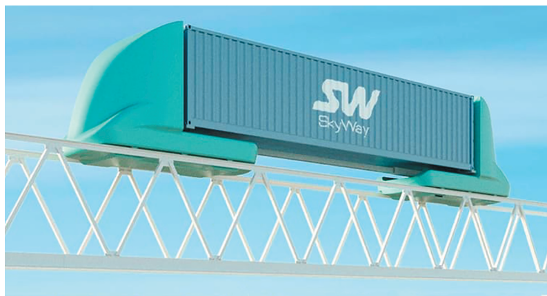
Рис. 1. Грузовое транспортное средство — навесной юниконт
