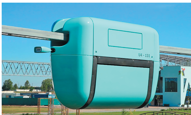
Рис. 2. Грузовое транспортное средство — подвесной юнитрак. «ЭкоТехноПарк», 2018 г.
