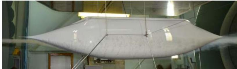
Рис. 3. Юнифлэш на продувке в аэродинамической трубе
