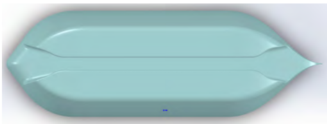
Рис. 8. Изменение геометрии заднего обтекателя в моделях № 3 и № 4 [выполнено авторами].
